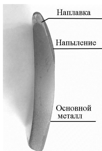
Рисунок 4. Поперечный темплет лопатки
