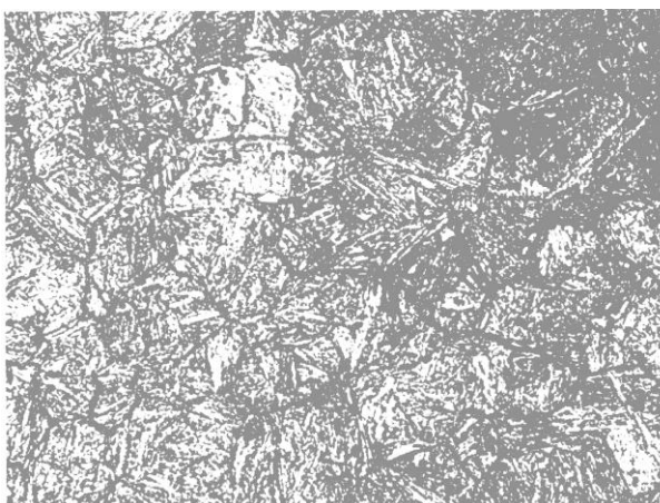
Рисунок 6. Микроструктура основного металла лопатки в ЗТВ наплавки (x500)
